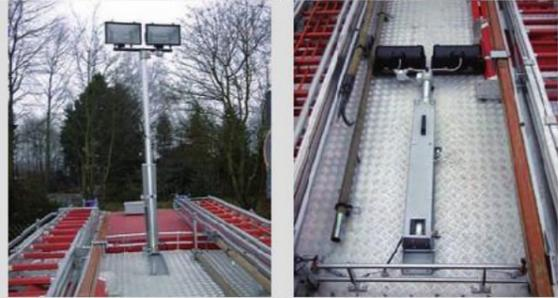
Ce système permet à un mât ENTRY d'être monté sur un toit de véhicule, et assure une mise en place manuelle rapide. La hauteur du véhicule vient s'ajouter à celle du mât. Les possibilités sont : 2 ou 3 sections pour une hauteur maximale de 3.5m au dessus du toit de véhicule avec une rampe de 2x1000W-230V.
