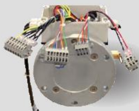
BOITE CABLEE A LA BASE DU MAT AVEC LE PLC – UNITE ELECTRONIQUE INTEGREE - CONNEXION POUR LA BASSE TENSION, LES PROJECTEURS 230V ET LES ELEMENTS DE SECURITE.
