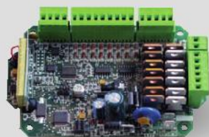
BOITE CABLEE A LA BASE DU MAT AVEC LE PLC – UNITE ELECTRONIQUE INTEGREE - CONNEXION POUR LA BASSE TENSION, LES PROJECTEURS 230V ET LES ELEMENTS DE SECURITE.
